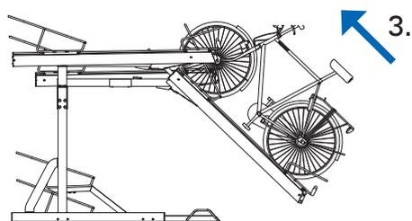
3. Heben Sie das Vorderrad des Fahrrads und stellen Sie das Vorderrad in die Schiene. Drücken Sie das Fahrrad nach oben und stellen Sie das Hinterrad in die Schiene.
