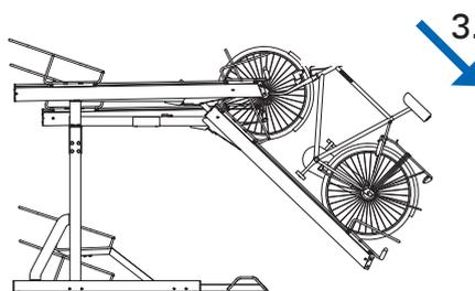
3. Heben Sie das Hinterrad von die Aussparung und rollen Sie das Rad nach unten. Stellen Sie das Fahrrad neben das Fahrradparksystem.
