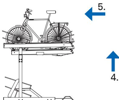
4. Heben Sie die Schiene, bis das Fahrrad eine aufrechte Stellung erreicht hat.
